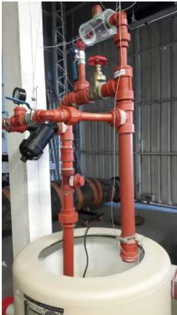
Figura 1. EFLAV. En el tanque se encuentra una bomba sumergible. La muestra se coloca a la salida de la línea. El flujo de agua con arena atraviesa la línea y genera erosión en la muestra, que puede cuantificarse por diferencia de peso o espesor.
