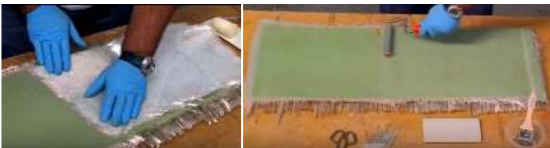
Figura 3. Laminado de compuesto con fibras bidireccionales.
