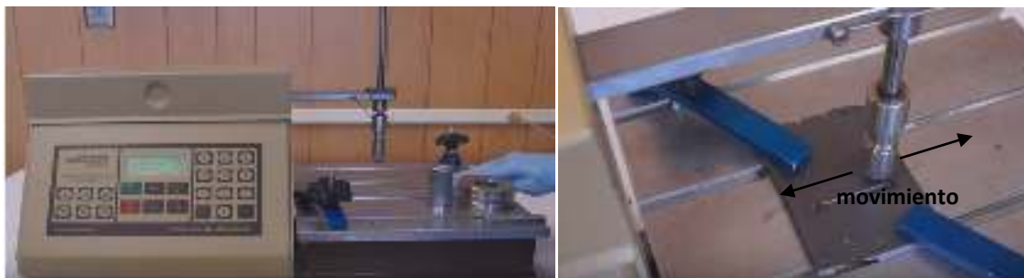
Figura 2. Test de abrasión lineal. Una punta ejerce presión sobre la muestra sólida, realiza movimiento de vaivén y genera un desgaste en la superficie, la cual puede determinarse por diferencia de peso o medición del surco.
